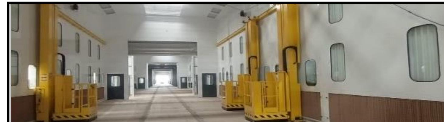
**A PLATAFORMA ELEVATÓRIA** é responsável pela movimentação vertical dos operadores no processo de pintura.
